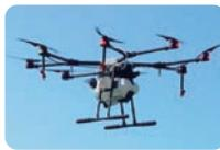
マルチスペクトルカメラを搭載したドローン
